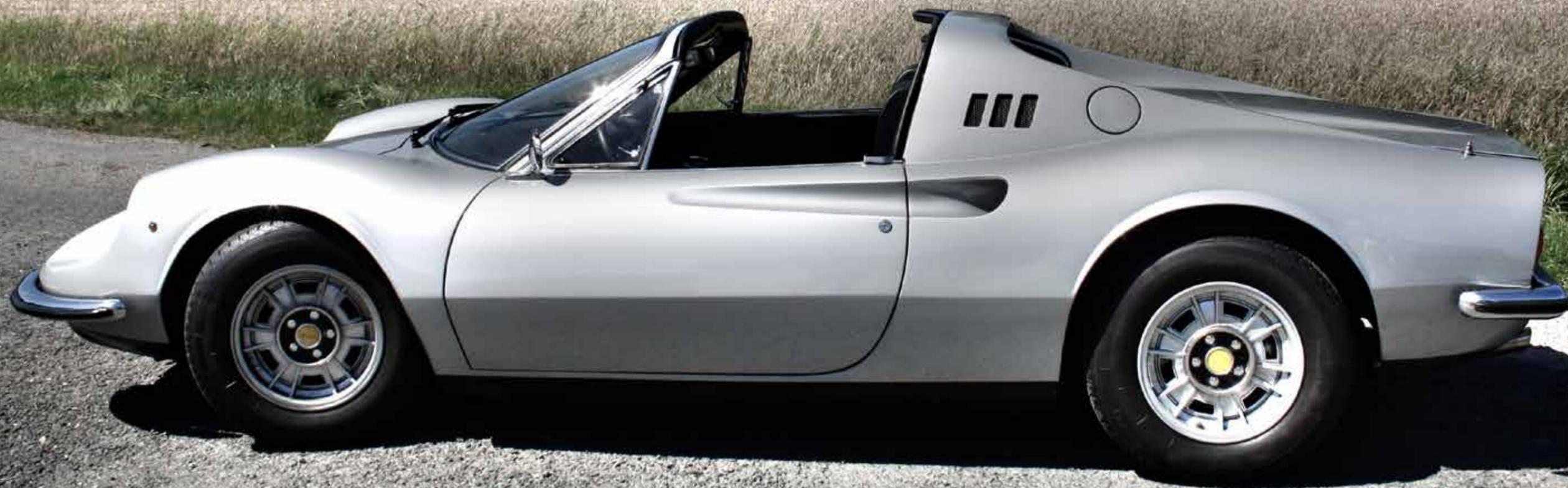
Der Spider war schwerer als das Ferrari Dino Coupé. Der Grund dafür waren die erhöhten Versteifungen und die eingesetzte Ganzstahlkarosserie, die auf einem Rohrrahmen aufgebaut wurde. Weich geschwungene Linien zeichnen die Seitenlinie des 246er Modelles.
