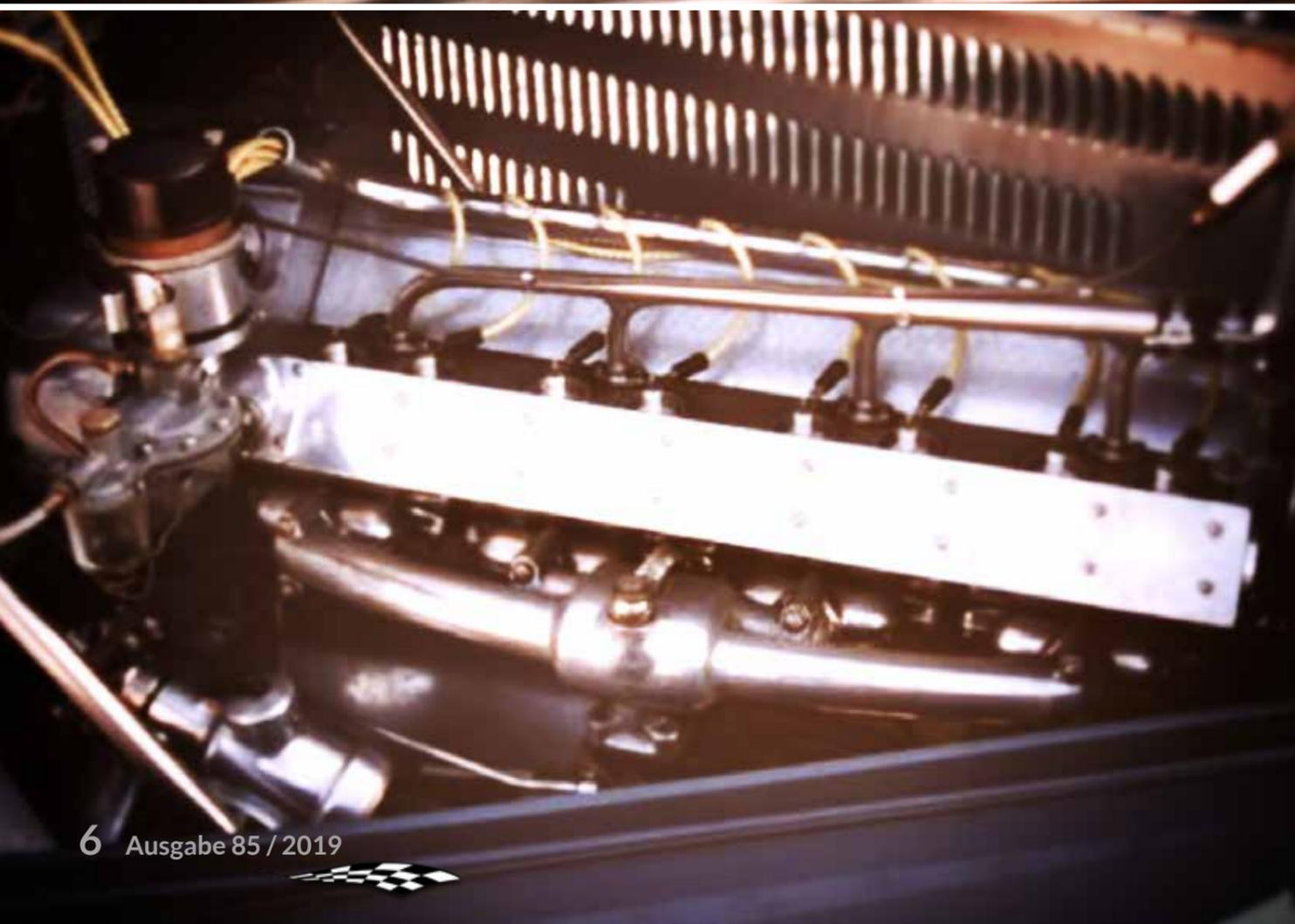
Der Type 57 ist mit einem herausragenden Motor ausgestattet. Der Reihen-Acht-Zylinder Motor mit 3,2 Litern Hubraum und 135 PS bei 5400 U/min ist äußerst lauffruhig. Es wird sogar behauptet, dass eine hochkant aufgestellte Münze auf dem Zylinderkopf sogar bei laufendem Motor stehen bleibt.
