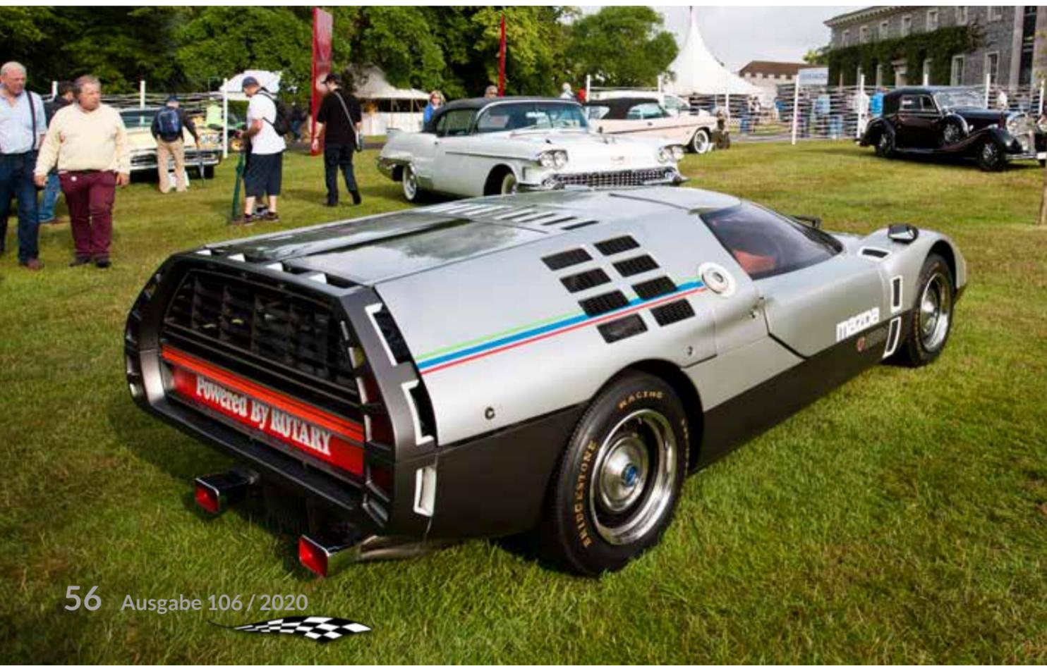
Der Mazda RX-500 war ein keilförmiger Sportwagen mit Mittelmotor und Hinterradantrieb und nach vorne öffnenden Schmetterlings-schwingtüren. Als Prüfstand für die Straßenverkehrssicherheit beworben, hatte er mehrfarbige Heckleuchten am Heck, die durch einen Farbwechsel anzeigten, ob das Fahrzeug beschleunigte, kreuzte oder langsamer wurde.
