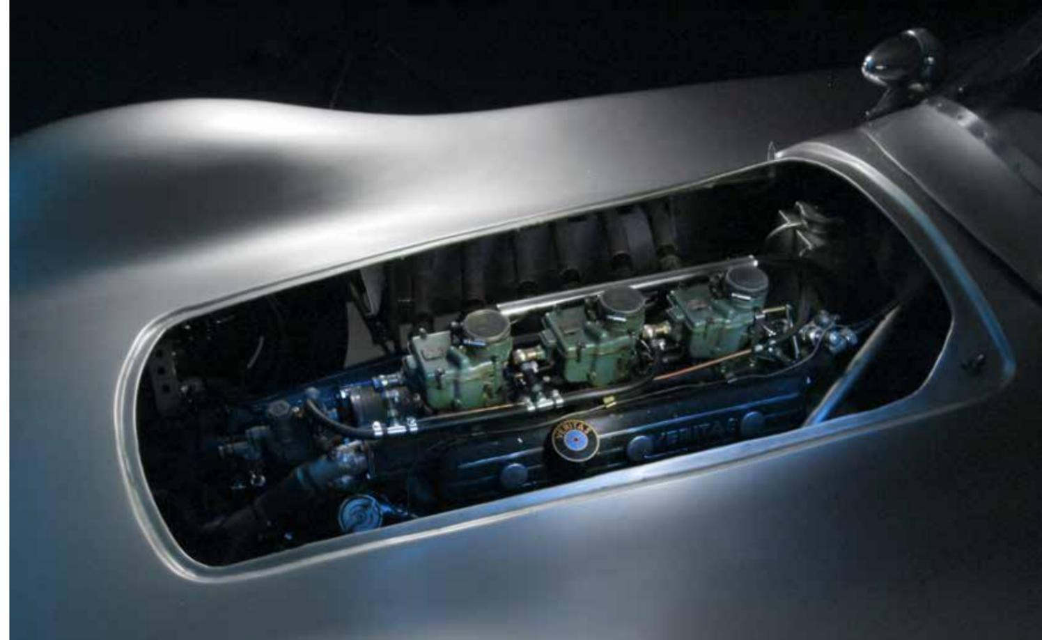
Die Karosserie erinnert sehr stark an die Avus Rekord-Stromlinien aus den 30er Jahren. Das Heck zieht sich tropfenförmig zusammen und die gesamte Karosserie ist extrem windschnittig optimiert. Ausgestattet mit einem 1988 ccm Reihen-Sechs-Zylindermotor mit 140 PS und einem Leergewicht von 560 kg erreichte das windschnittige Rennfahrzeug eine Höchstgeschwindigkeit von bis zu 250 km/h.
