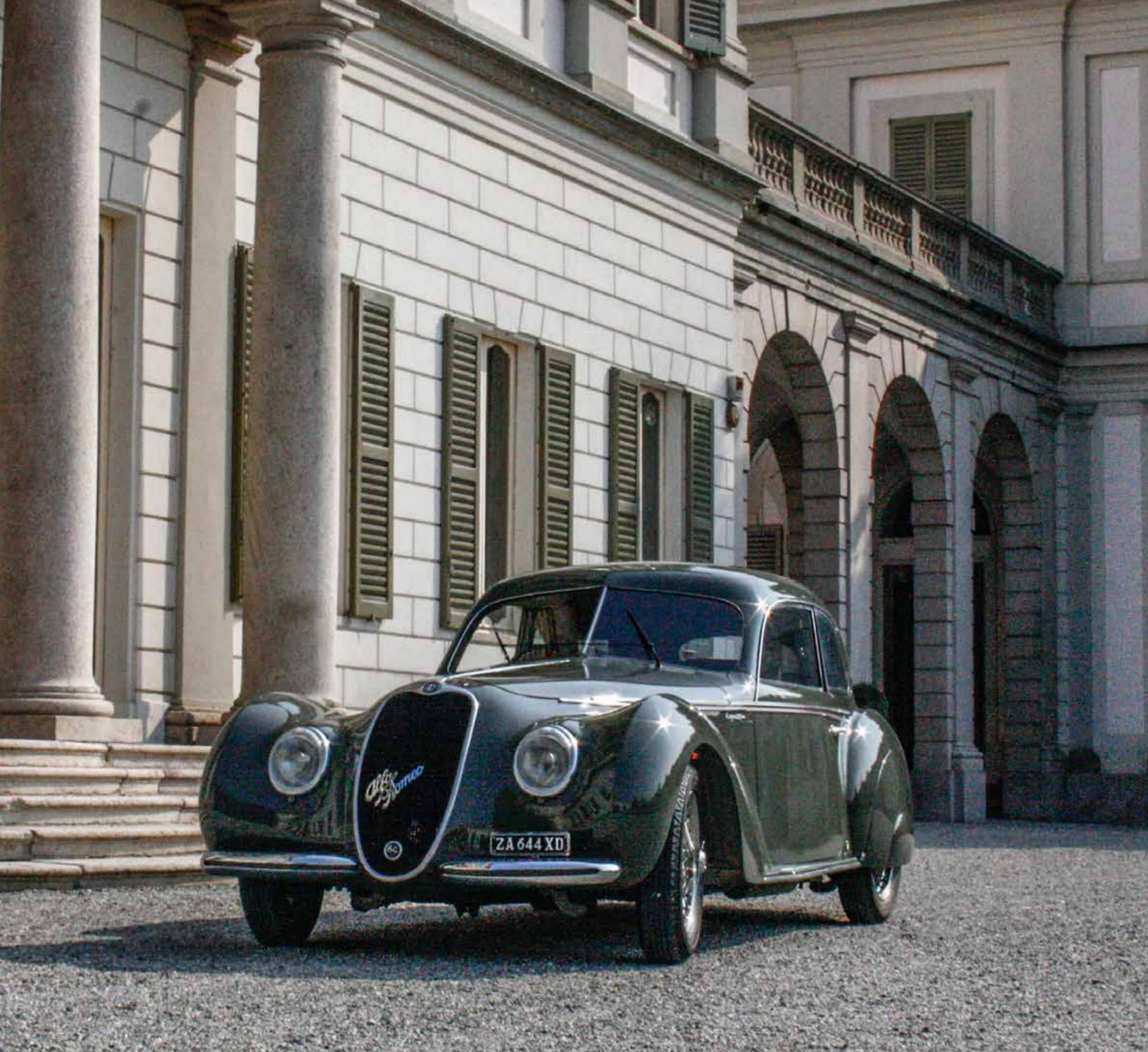
Leider fand die Mille Miglia 1940 dann aber aufgrund der politischen Probleme nicht statt. Dadurch kam dieses auf einem verkürzten Chassis aufgebaute Fahrzeug nie zum geplanten Einsatz. Die stromlinienförmige Karosserie ist insgesamt in einer Leichtbauweise aus Aluminium aufgebaut. Der hier gezeigte Prototyp ist heute noch in der Originalfarbe lackiert.
