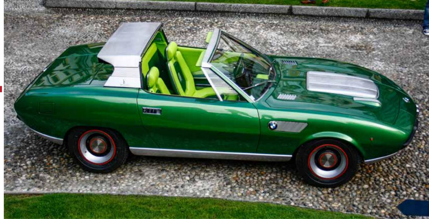
In der Mitte der Stoßstange unterbricht die Doppelniere die Frontlinie. Allerdings ist die Doppelniere funktionslos, da keine Lüftungsöffnung dahinter sitzt. Ausgestattet ist der Spicup mit dem 170 PS-starken Sechszylinder-motor des BMW 2800. Da der Motor wegen seiner Bauhöhe nicht in die flach verlaufende Karosserie passte, entwarf Gandini eine Kunststoffhülle, die in die Motorhaube eingesetzt wurde.
