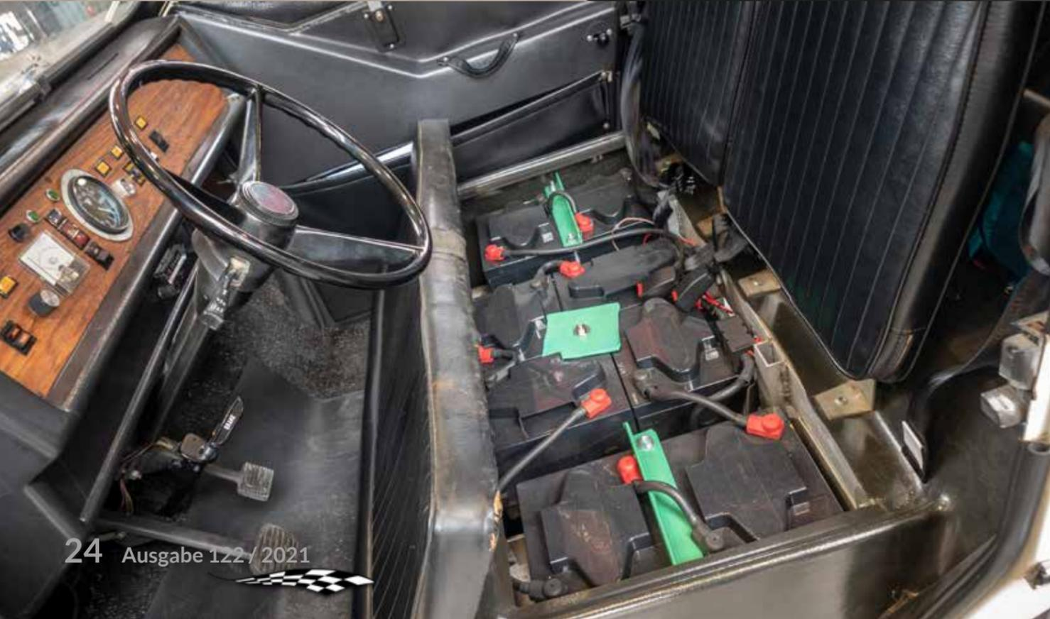
Man baute auf die Umwelt. Der kleine City-Flitzer hat ganze 3,5 PS unter der Haube. Damit erreicht er eine Maximalgeschwindigkeit von ca. 62 km/h. Die Reichweite mit einer Batterieladung liegt laut Herstellerangaben bei rund 60 Kilometer. Die Nennleistung liegt bei 48 Volt und wird durch acht 6-Volt-Hochleistungsbatterien erreicht. Die aneinandergereihten Batterien befinden sich unter der vorderen Sitzbank.
