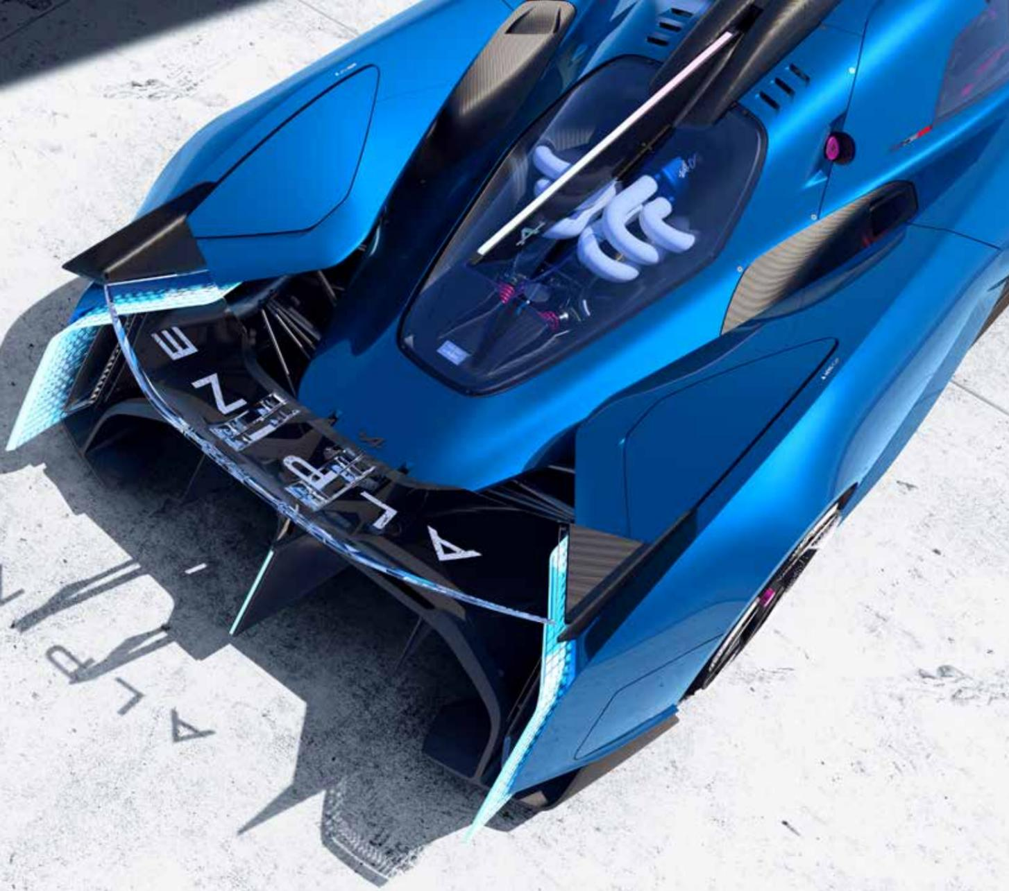
Der Alpenglow ist mit drei Hochdruck-Wasserstofftanks (je 2,1 kg) ausgestattet, die in den Seitenkästen und am Heck untergebracht und vom Cockpit isoliert sind, um die Sicherheit zu maximieren. Zu den Sicherheitsmaßnahmen gehören Tanks, die nach Vorschrift 134 zertifiziert sind, Schnellablassventile für den Kraftstoff im Brandfall, Wasserstoffsensoren und ein farbcodiertes Warnsystem für die sofortige Risikokommunikation an Fahrer und Rettungskräfte.
