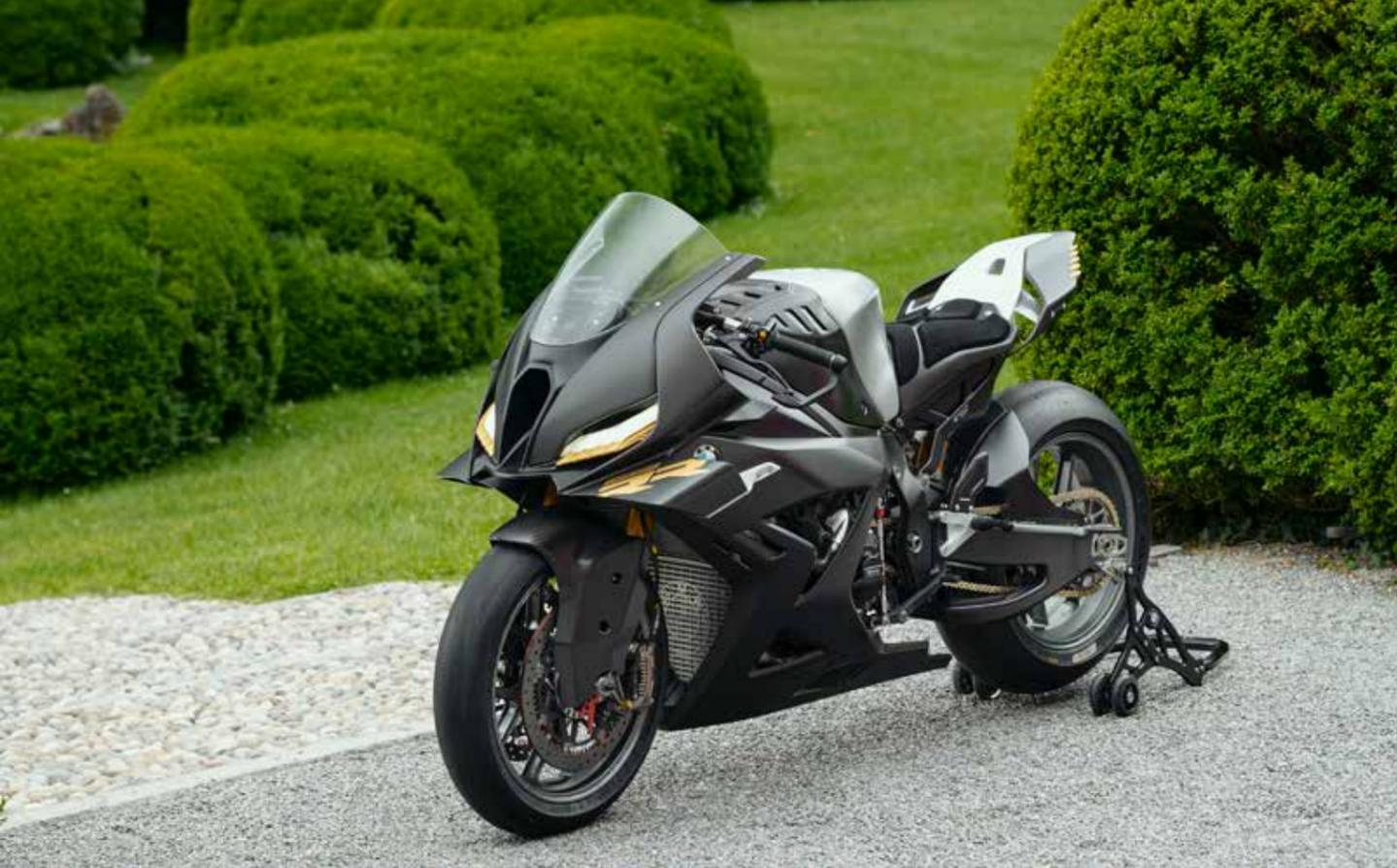
Besondere Aufmerksamkeit widmeten die Ingenieure der Aerodynamik – mit klar definierten Zielen: Stabilität bei Höchstgeschwindigkeit, maximale Kurvengeschwindigkeit und minimaler Luftwiderstand. Diese scheinbar widersprüchlichen Anforderungen vereint die Concept RR in einem hochkompakten, durchlüfteten Gesamtkonzept. Von der Front bis zum aerodynamisch geformten Heck strömt der Fahrtwind kontrolliert durch das Motorrad – für optimale Performance im Grenzbereich.
