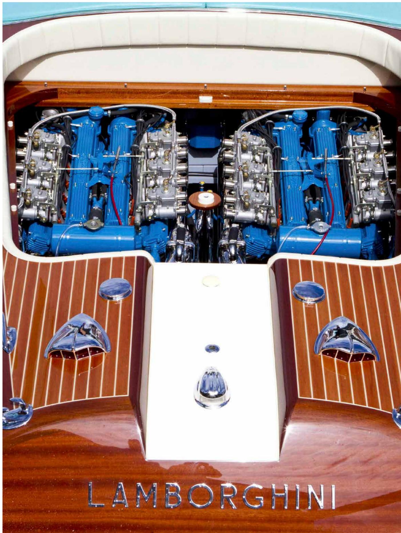
Der V12-Motor war zu diesem Zeitpunkt das mechanische Herzstück von Lamborghini. Ein hochdrehender Aluminium-Motorblock mit sechs Doppelvergasern, der auch im Miura seine Oper sang – und nun auch auf dem Wasser seine Stimme erhob. Im Riva Super Aquarama leisteten die beiden Aggregate zusammen rund 700 PS. Das Ergebnis war nicht nur imposant, es war spektakulär: eine Höchstgeschwindigkeit von über 90 km/h – ein Wert, der selbst heutige Luxusboote in den Schatten stellt.
